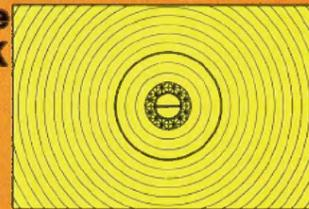
C'est une combinaison des types A (stigmomètre) et J (microprismes). Permet une mise au point rapide et précise. Convient à la photographie en général.
