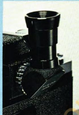
Monté sur l'oculaire des viseurs à prisme en toit ou Photomic, ce viseur permet une visée à  $90^\circ$  par rapport à l'axe optique de l'appareil. Avec un objectif de 50 mm, le grossissement de la visée est d'environ 0,6 X. Compte tenu de la valeur dioptrique du viseur, qui le reçoit, le viseur d'angle permet des corrections de  $-5$  à  $+3$  dioptries.
