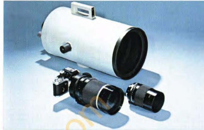
Ce sont des objectifs à miroirs conçus suivant le principe des grands télescopes astronomiques. Sur les objectifs classiques la lumière suit un chemin unidirectionnel. Avec les objectifs à miroirs tels que les Reflex-Nikkor, la lumière est réfléchi deux fois, effectuant le même parcours en moins d'espace.
