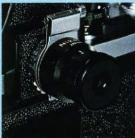
Elle se visse sur l'oculaire viseur. Son grossissement 2 X permet de pousser la mise au point. Montée sur un support à charnière, elle peut être basculée hors du champ de visée si nécessaire. Compte tenu de la valeur dioptrique du viseur la loupe permet des corrections de  $-5$  à  $+1$  dioptries.
