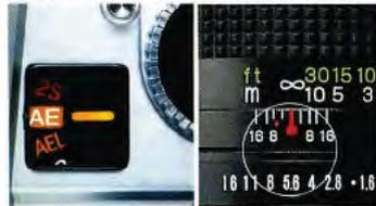
En positionnant le disque de sélection sur "AE" ou "AEL", et en réglant le diaphragme voulu, on obtiendra des photos toujours parfaitement exposées. Les vitesses d'obturation seront automatiquement réglées. Des vitesses lentes: 2 secondes, aux vitesses rapides: 1/1000<sup>e</sup> sec. Les réglages du diaphragme sont visibles
