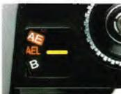
La position "AEL" sur le disque de sélection des vitesses indique "verrouillage de l'exposition". Cette fonction dite "mémorisation" permet de faire facilement des compensations supplémentaires d'exposition lorsque l'on travaille en mode priorité à l'ouverture et en programme AE. On appuie à mi-course sur le déclencheur jusqu'à ce que l'on relâche le déclencheur ou bien jusqu'à ce que l'on déclenche complètement.
