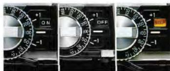
Ce déclencheur se manipule facilement et doit être remis en position "OFF" dès qu'on n'utilise pas l'appareil afin d'économiser les piles. Ce déclencheur sert aussi pour la mise en route du déclenchement à retardement.
