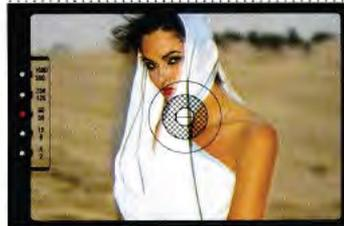
L'affichage LED dans le viseur indique la vitesse d'obturation, signale la sur ou sous exposition et renseigne sur l'état des piles évitant à l'oeil d'être obligé de quitter le viseur pour vérifier ces informations. Ce viseur très clair, très lumineux, permet trois systèmes de mise au point, télémètre, microprisme et verre dépoli, pour une mise au point rapide et précise dans n'importe quelle condition et avec n'importe quel type d'objectif.
