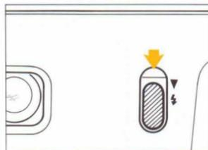
Utiliser le flash si le témoin rouge (témoin d'avertissement de sous-exposition) s'allume en appuyant à mi-course sur le déclencheur. Vérifier que la tête du flash n'est pas masquée par des cheveux ou par un doigt.
