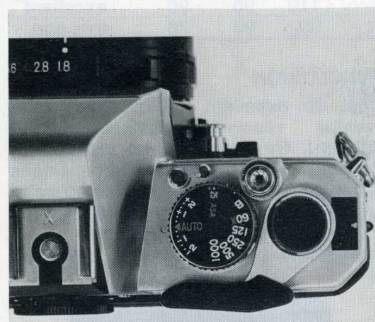
Le bouton des temps de pose en position « AUTO ». Si l'on veut passer au contrôle manuel, il faut commencer par presser la manette qui est devant le bouton vers l'intérieur. A côté du bouton des temps de pose, le déclencheur à verrouillage.
