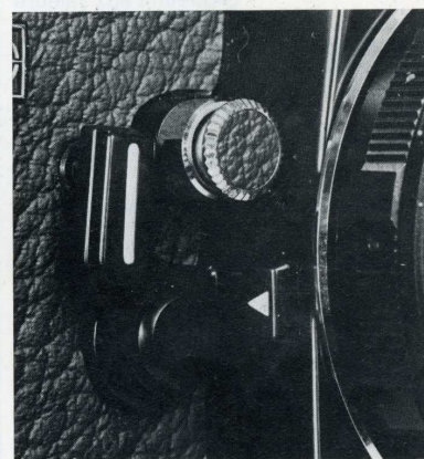
Le bouton de profondeur de champ, qui doit être enfoncé et, pour les objectifs non-automatiques doit, de plus, être tourné d'un quart de tour, de façon à continuer de jouir du posemètre. Le déclencheur à retardement et le verrou d'objectif sont montés très près l'un de l'autre. Le verrou d'objectif aurait pu être un peu plus grand.
