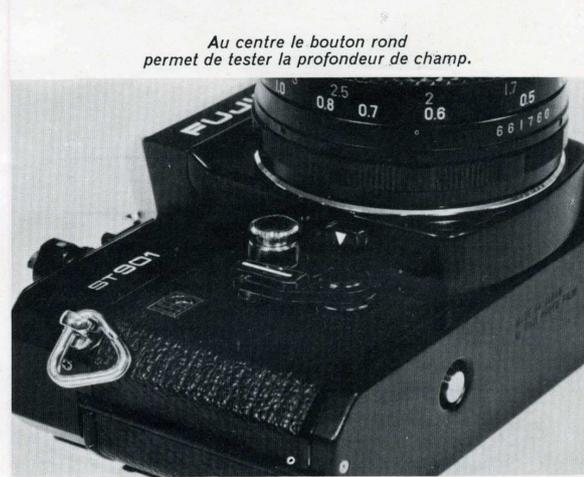
*Au centre le bouton rond permet de tester la profondeur de champ.*
